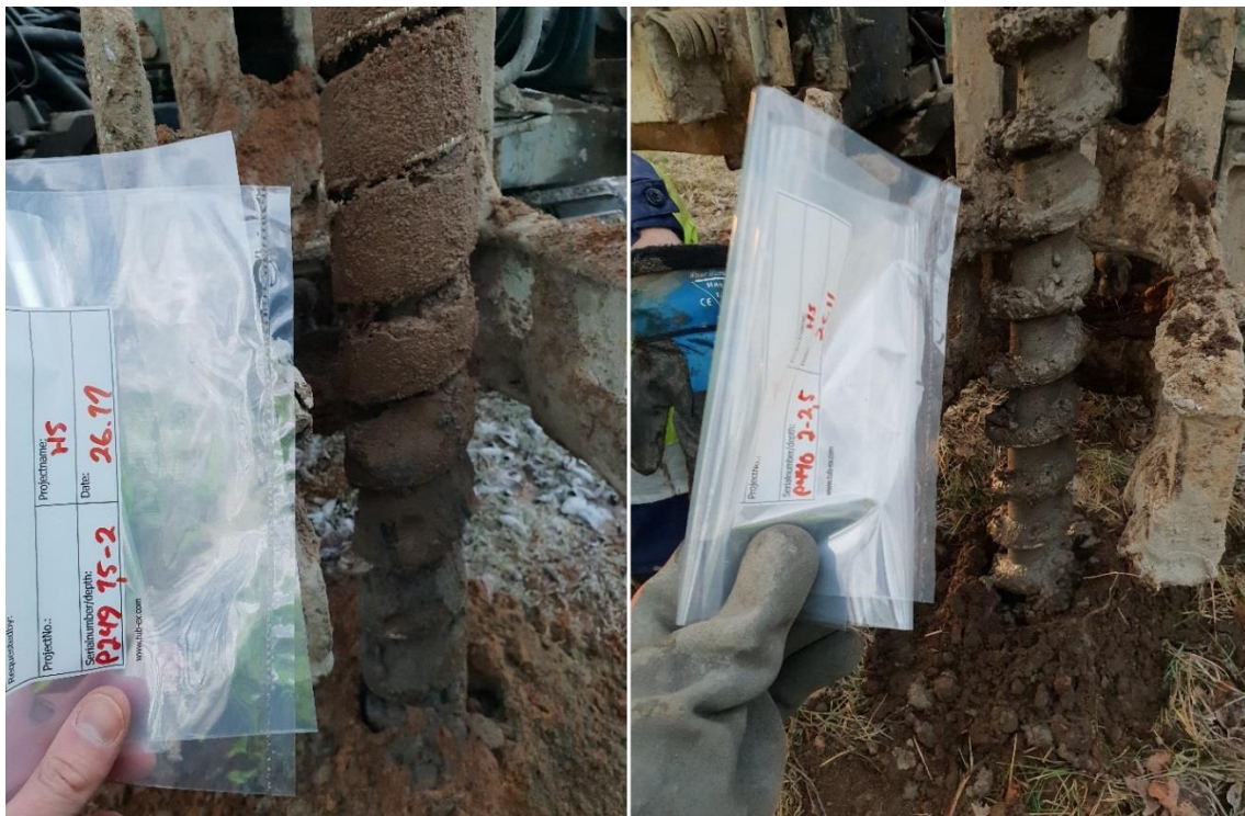
Kuva 3-2. Tutkimuspisteen P249 syvyydeltä 1,5...2,0 m ja P440 syvyydeltä 2...2,5 m otetut näytteet näytteenottimessa.
