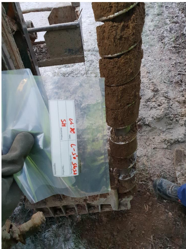
Kuva 7. Maa-aines näytepisteen P454 syvyydellä 0,5...1,0 m.
