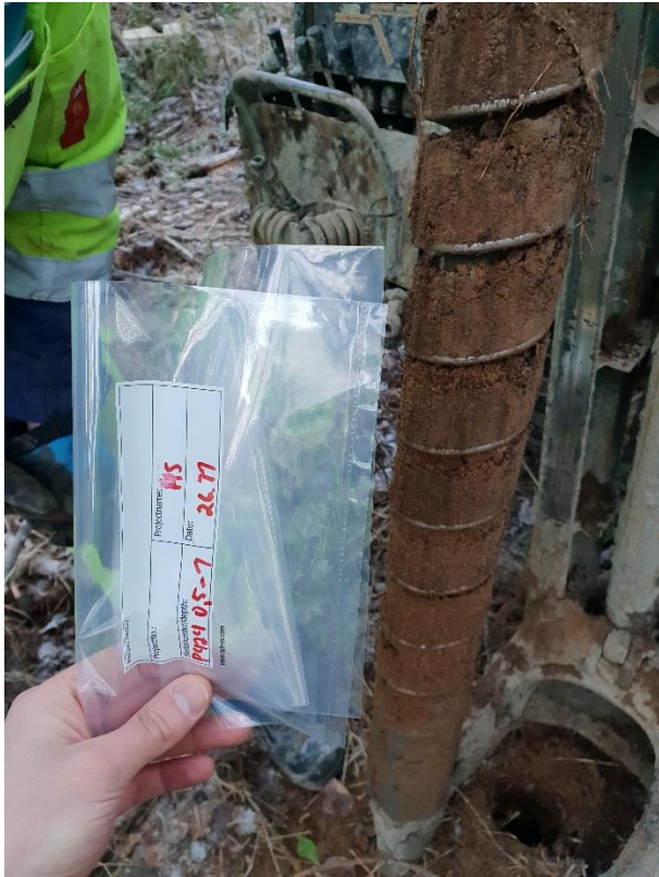
Kuva 1. Maa-aines näytepisteen P424 syvyydellä 0,5...1,0 m.
