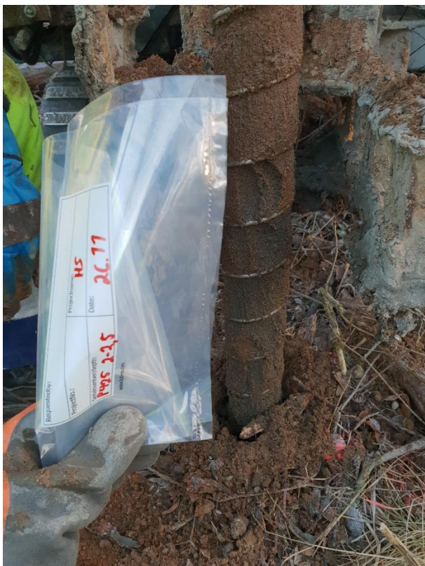
Kuva 2. Maa-aines näytepisteen P425 syvyydellä 2,0...2,5 m.
